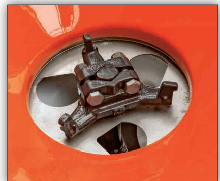
Rührfinger garantiert gleichmäßigen Düngierzufuhr
